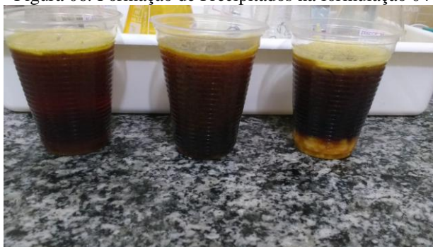
Figura 06: Formação de Precipitados na formulação 04
