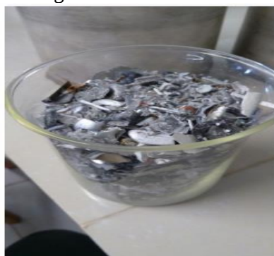
Figura 3 - Resíduos fragmentados retirados do moinho de martelos
