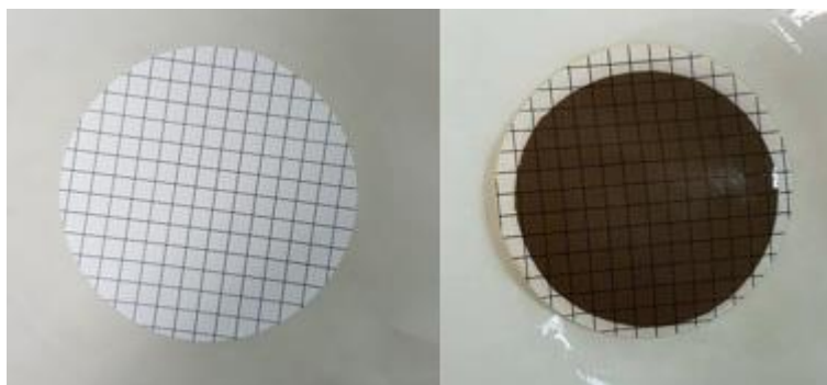
Figura 1 – Membrana antes (esquerda) e após (direita) a filtração.
