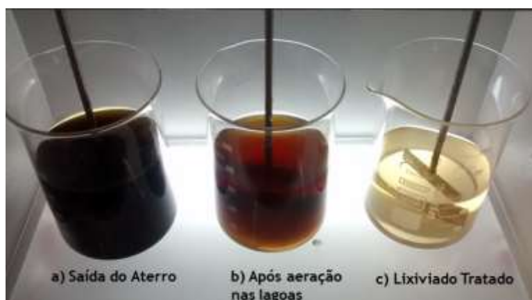
Figura 2- (a): lixiviado após a saída do aterro sanitário, (b) lixiviado após o pré tratamento nas lagoas de estabilização (c) lixiviado após processo de coagulação, floculação e decantação
