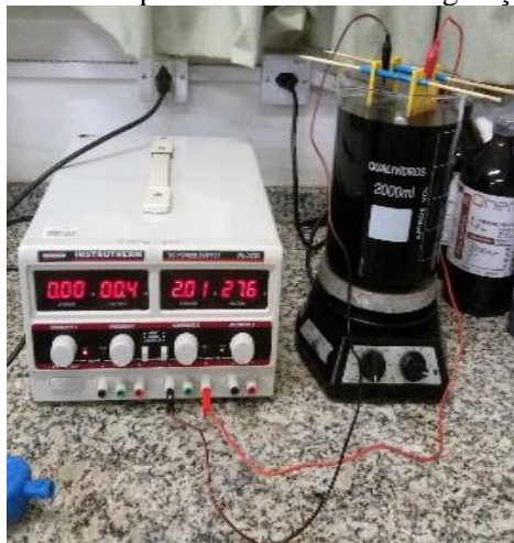
Figura 1 - Procedimento experimental da eletrocoagulação em sistema de batelada
