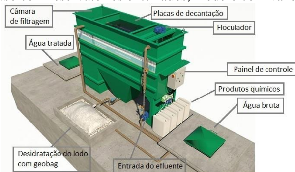
Figura 2. ETA de reuso com reservatórios enterrados, modelo com vazões de 800 a 5.000 l/h.
