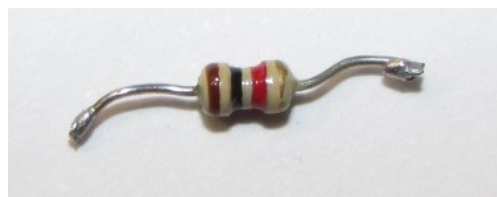
Figura 6 – Componentes do circuito elétrico para captura de voltagens V_{rms} e resistor de 1000 OHMS
