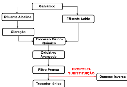
Figura1 - Diagrama atual da estação de tratamento de efluentes galvânicos e a substituição pelo PSM sugerido nesse trabalho.
