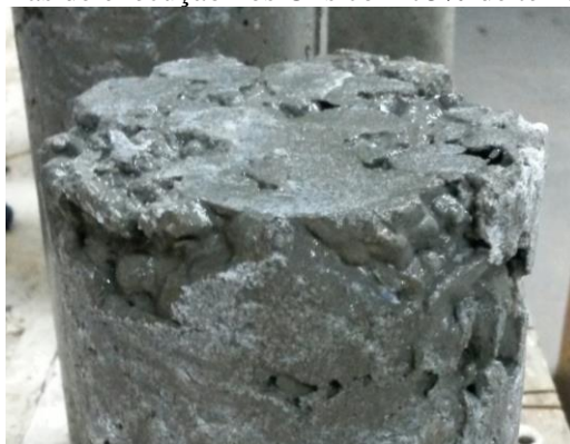
Figura 1: Problemas de execução nos CPs com 75% de telha de fibrocimento
