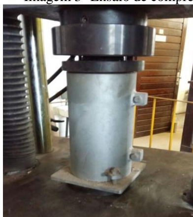
Imagem 3- Ensaio de compressão.
