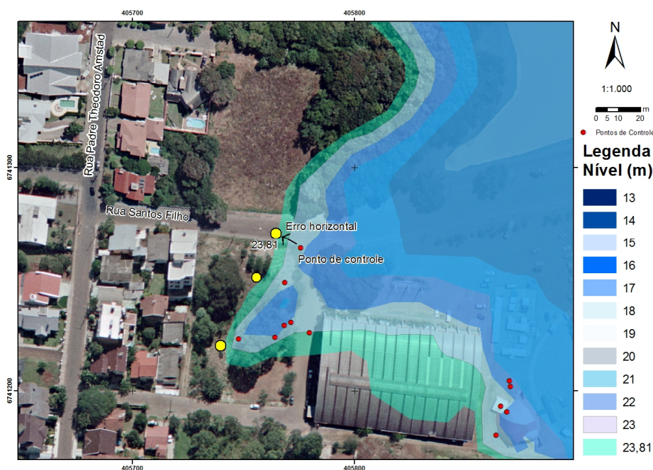
Figura 5- Diferença entre a área de inundação mapeada e a observada
