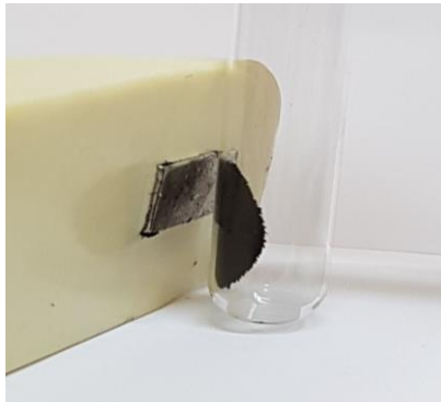
Figura 2 Partículas de Ferrita de cobalto sendo atraídas por um ímã.
