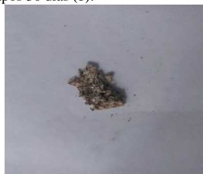
Figura 1: Amostra de algodão em estrutura plana antes do teste de biodegradabilidade (a), amostra de algodão em estrutura plana após 30 dias (b).
