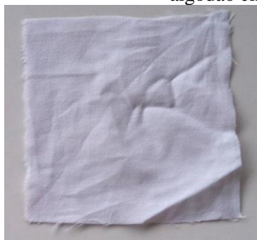
Figura 1: Amostra de algodão em estrutura plana antes do teste de biodegradabilidade (a), amostra de algodão em estrutura plana após 30 dias (b).
