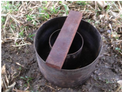
Figura 02- Ensaio de Infiltração com anéis concêntricos.
