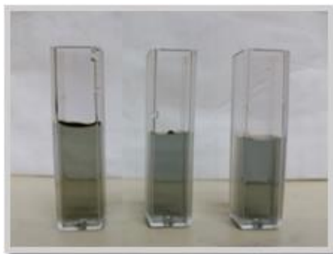
Figura 8: Solução aquosa de 50 \text{ mg L}^{-1} do corante AB-210 durante processo de Fenton, com o sistema 18,02 \text{ mg L}^{-1} de \text{H}_2\text{O}_2 (10:01), nos tempos 0, 15 e 30 minutos.
