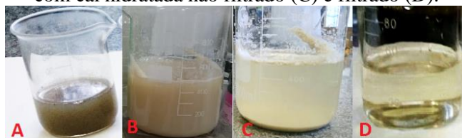
Figura 1 - Efluente de suinocultura antes (A), durante (B) e após o tratamento por meio da ozonização com cal hidratada não filtrado (C) e filtrado (D).
