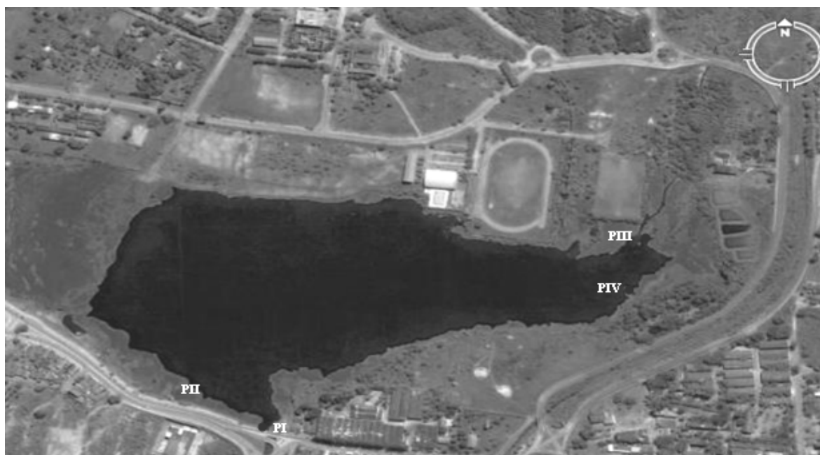
Figura 1 - Imagem do Açude de Bodocongó mostrando o avanço do assoreamento ao longo do reservatório.
