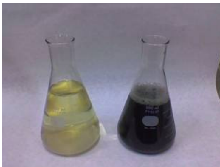
Figura 2 - Fotografia do chorume bruto (direita) e após o tratamento com o SF-Pirita (esquerda)
