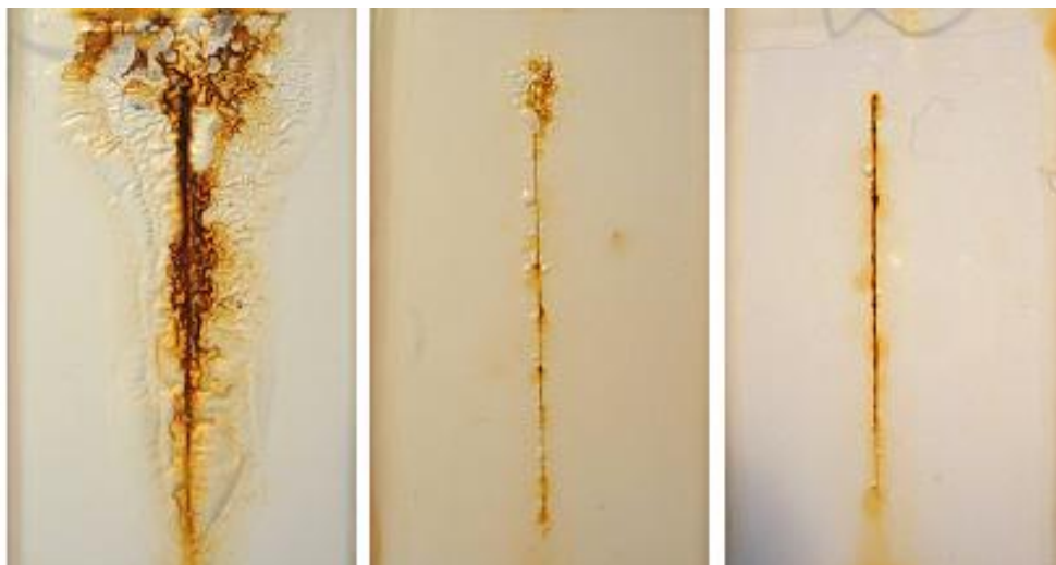
Figura 1: Ensaio de migração em Névoa Salina em chapas contendo revestimento de conversão à base de Zr/Ti, nos tempos de imersão de 30, 60 e 120 s respectivamente.
