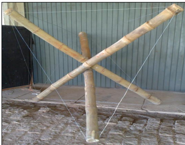
Figura 7 - “Jack” de bambu e arame.
