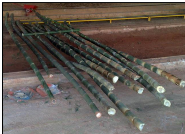
Figura 4- Armazenamento e secagem das peças de bambu ao abrigo do sol e da chuva e distante do solo.
