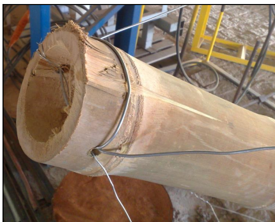
Figura 5- Detalhe mostrando a configuração da amarra da extremidade da estaca com arame nº. 12.
