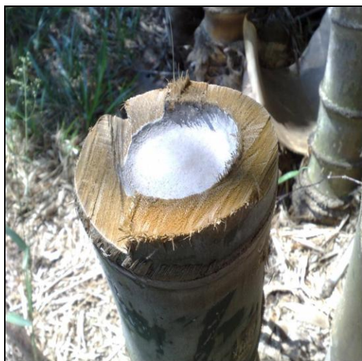
Figura 3- Corte da peça rente ao nó para evitar acúmulo de água da chuva.
