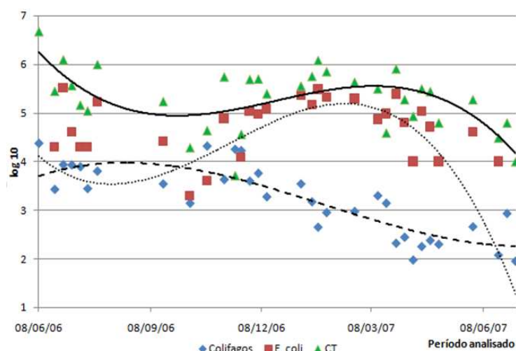
Figura 5: Linhas de Tendência do comportamento dos microrganismos analisados: Colifagos, E. coli e Coliformes Totais, no efluente reator de Lodos Ativos, no período de junho de 2006 à julho de 2007.
