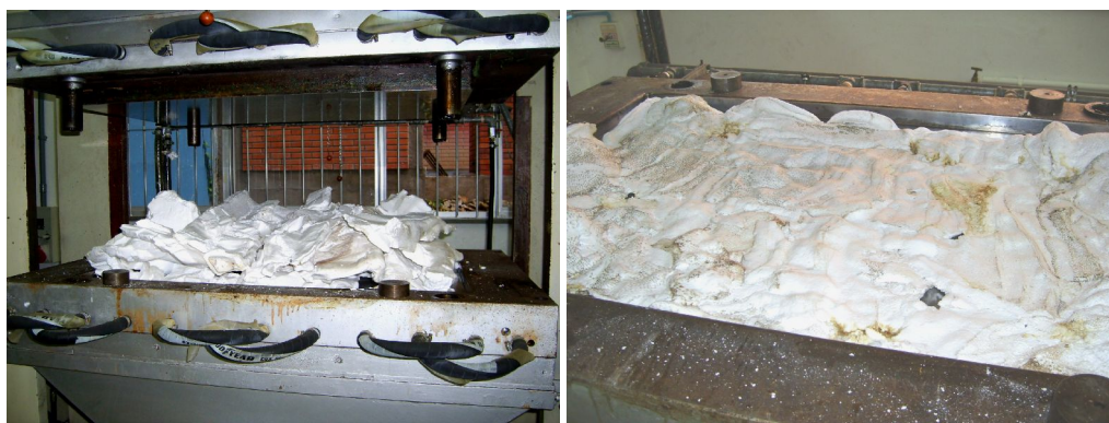
Figura 1: Resíduos de EPS antes e após moldagem por compressão
