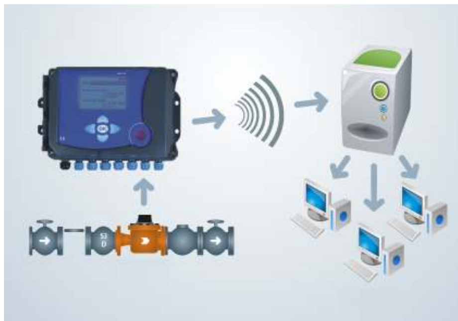
Figura 01 - desenho esquemático do funcionamento do sistema de telemedição.
