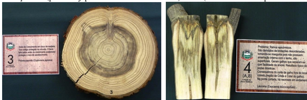
Figura 1 – Peças nº 3 (pinheiro-japonês - anéis de crescimento) e nº 4 (leucena – ramos epicórmicos e necrose).
