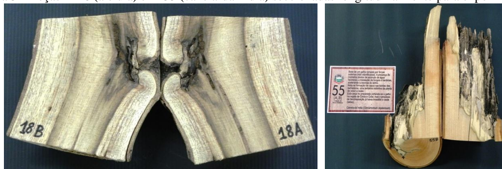
Figura 3 – Peças nº 18 (aleluia) e nº 55 (canela-da-índia) seccionadas longitudinalmente para expor necrose.
