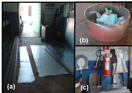
Figura 3 - Excesso de materiais depositados obstruindo a saída (a), descarte incorreto de chapas metálicas(b) e Equipamento de Proteção Coletiva (c).
