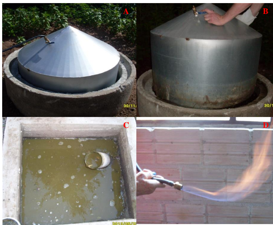
Figura 2 – (A) Biodigestor, (B) movimentação do gasômetro, (C) biofertilizante e (D) queima biogás.
