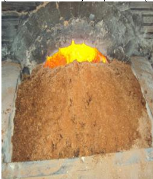
Figura 4 - Mistura do caroço de açaí com serragem.
