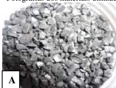
Figura 1 – Fotografias dos materiais utilizados: (A) Carvão ativado granular e (B) Óxido de ferro granular
