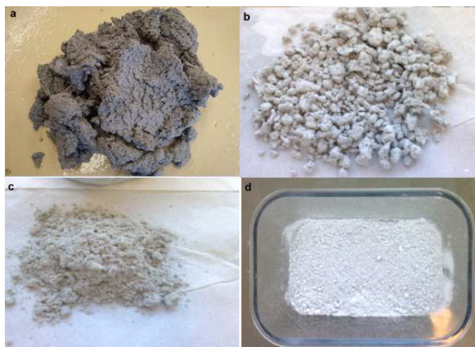
Figura 1. Fases da preparação do resíduo: a) resíduo recém-coletado da prensa desaguadora; b) resíduo após secagem; c) resíduo após moagem; d) amostra de interesse após o peneiramento.
