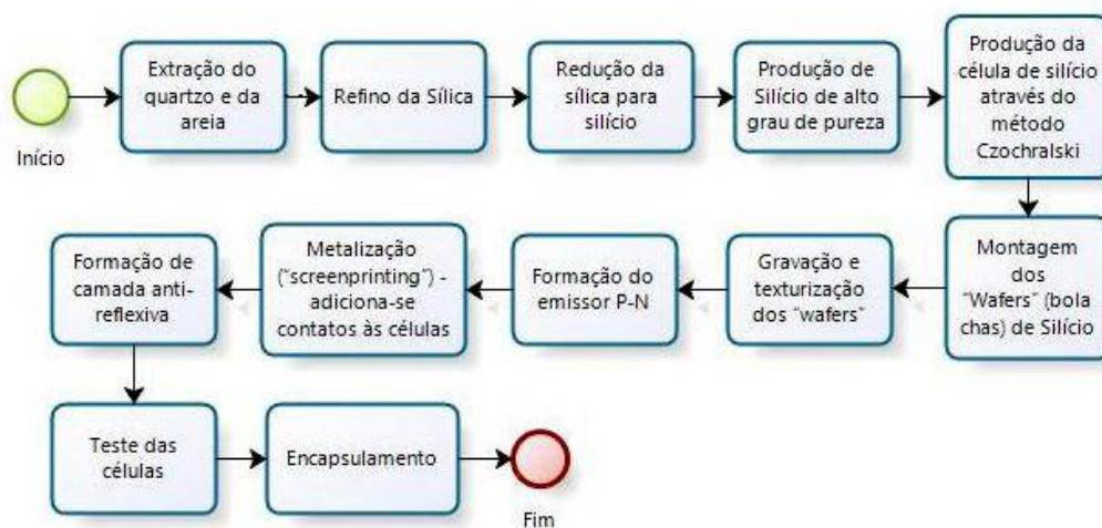
Figura 1 – Fluxograma das etapas do processo de fabricação de células de silício
