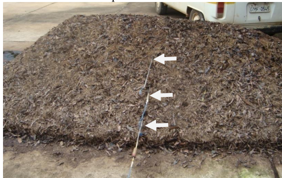
Figura 71 - Seção longitudinal da leira estática aerada, destacando-se a posição das sondas para leitura de temperatura
