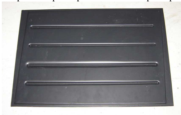
Figura 2 – Vista superior do protótipo de coletor solar plano polimérico
