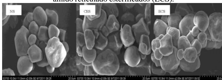
Figura 2 - Micrografia de análise superficial (SEM) do amido nativo (NS), amido esterificado reticulada (CES), amido reticulado esterificados (ECS).
