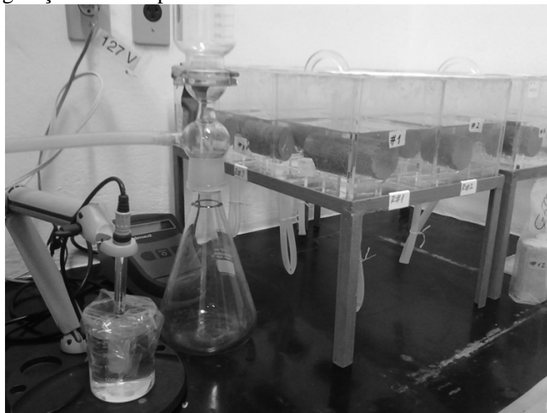
Figura 1. Configuração do teste para medida da condutividade elétrica da solução lixiviada
