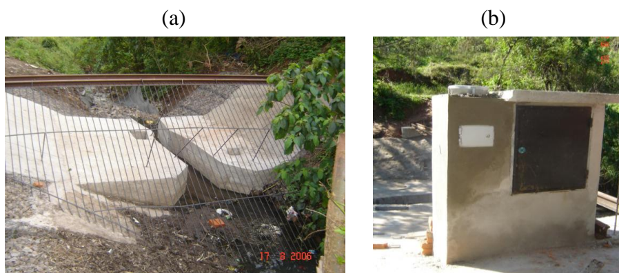
Figura 2 - Calha Parshall onde está instalado o sensor de medida da vazão (a) e abrigo do registrador de vazão e do pluviógrafo (b).
