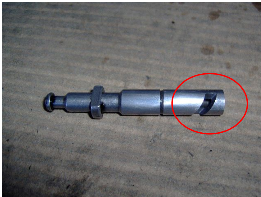
Figura 3 - Detalhe da região desgastada no elemento da bomba injetora
