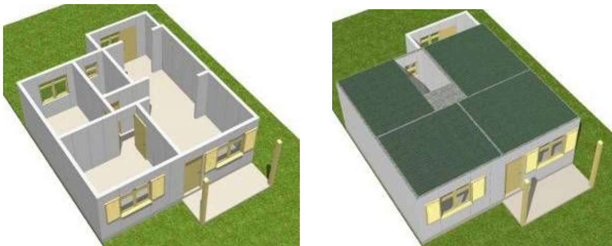
Figura 5: a - montagem dos painéis de parede e b - colocação dos painéis de cobertura.
