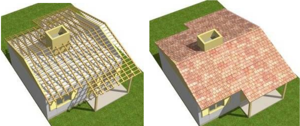
Figura 6: a – execução da estrutura da cobertura e b - colocação de telhas.
