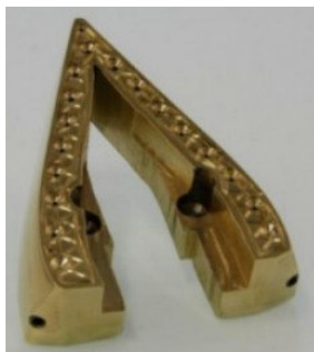
Figura 3 - Novo bico injetor desenvolvido. Fonte: ECOTIME
