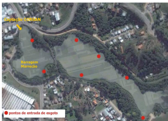
Figura 5: Pontos de entrada de efluentes não tratados no manancial. Fonte: Google Earth, alterada pelos autores.
