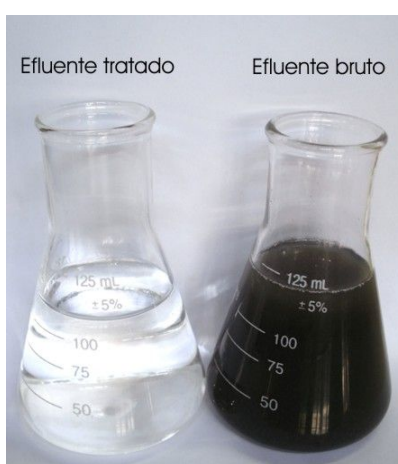
Figura 2 - Comparação do efluente tratado com o efluente bruto pelo processo foto-Fenton com radiação solar, em tempo de reação de 60 minutos.
