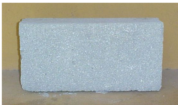
Fig. 6 – Bloco de argamassa de cimento com agregado de resíduo plástico termofixo
