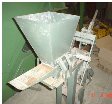
Fig. 3 – Máquina de fabricação de blocos de solo-cimento da UFRN.
