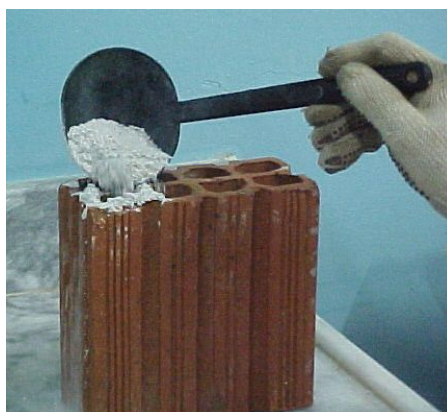
Fig. 5 – Enchimento de bloco cerâmico com resíduo plástico termofixo
